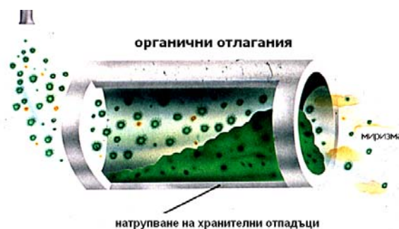
Фиг.2. Натрупване на отлагания в отходни тръби
