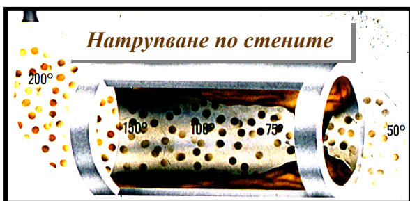
Фиг.1: Запушване/затлачване на отходни тръби
